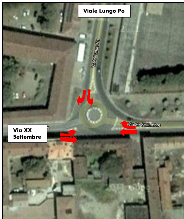
Figura 9: Movimenti di svolta all'intersezione tra viale Lungo Po e via XX Settembre
